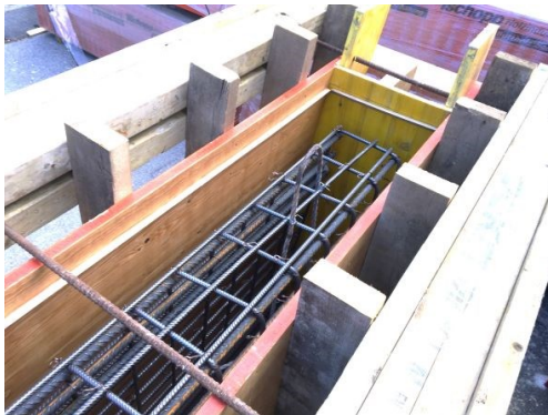
Abb. 5.2 Querschnitt des Musters (Nachbildung eines Brüstungselementes)
