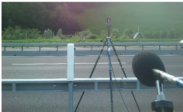
Abbildung 7: Mikrofonpositionen bei einer SPB-Messung.
