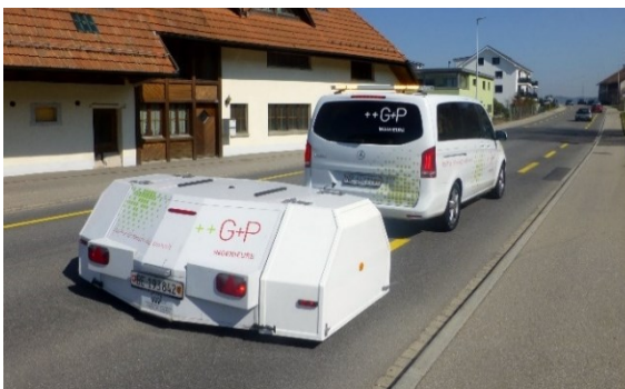
Abbildung 5: Bild des von Grolimund + Partner AG verwendeten CPX-Messanhängers.
