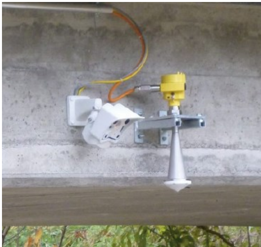
Abb. 7.39 Der Pegel-Radar (rechts) misst die Distanz zur Wasseroberfläche. Die Webcam (links) liefert zusätzlich wertvolle Bilder [63].
