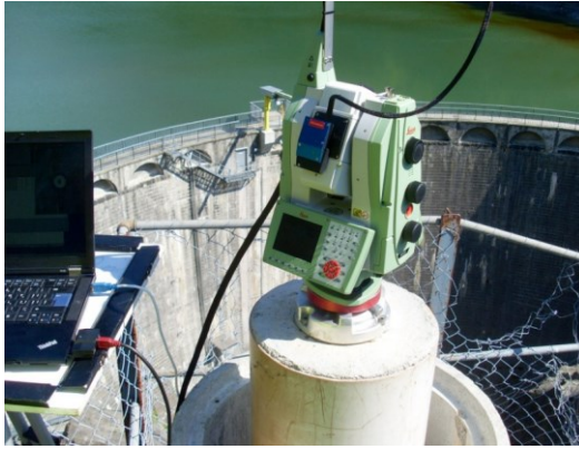
Abb. 8.112 Anwendung des Daedalus-Systems bei der Staumauer "Montsalvens" (links, [237]) und die Verarbeitungsschritte eines Algorithmus für die Zielerkennung eines Daedalus-Systems (rechts, [234]).
