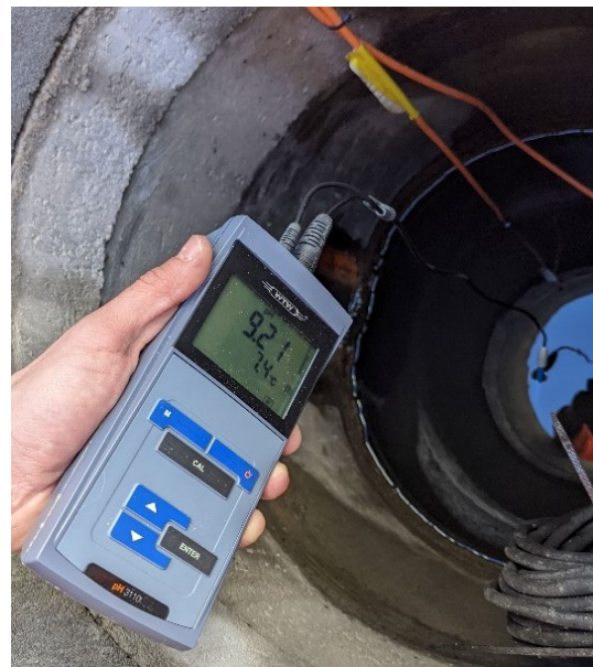
Abb. 7.84 Visuelle Auswertung eines pH-Messstreifen (links) und elektrische Messung des pH-Werts in einem Schacht (rechts) [163]
