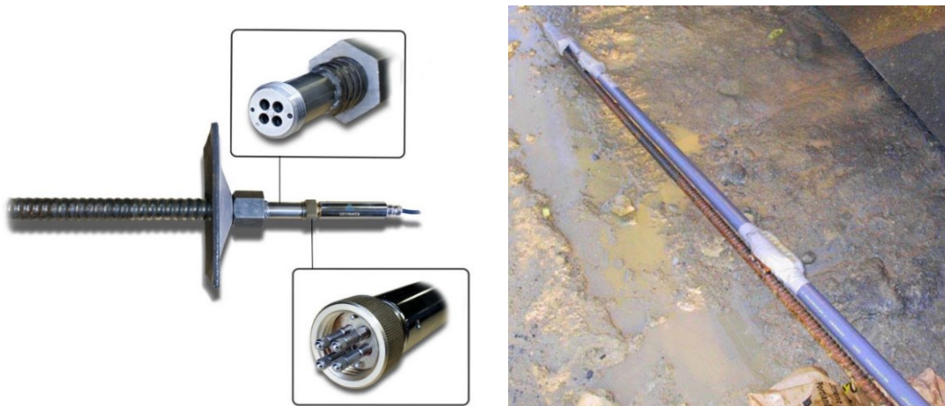
Abb. 7.74 Detail eines 4-fach Messkopfs (links,[134]) sowie Darstellung eines Messankers mit Gleitmikrometer-Messrohr (rechts,[135])
