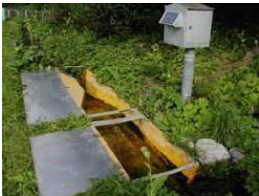
Abb. 7.65 Venturi Kanal einer Quellschüttung [113]
