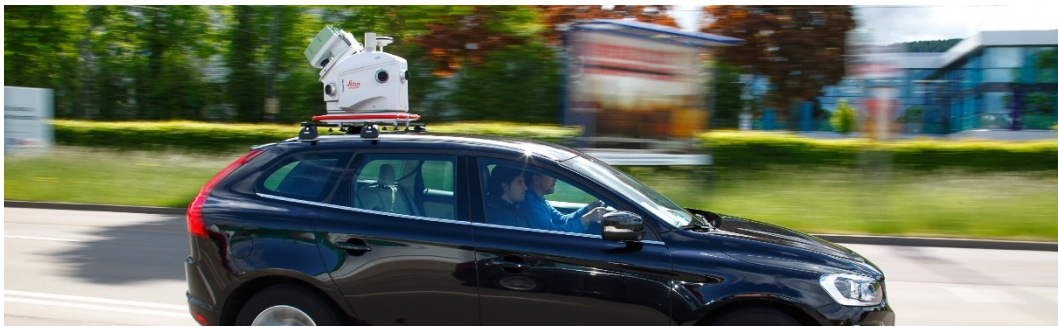
Abb. 8.121 Mobile Mapping System auf einem Strassenfahrzeug mit einem Laserscanner [274].
