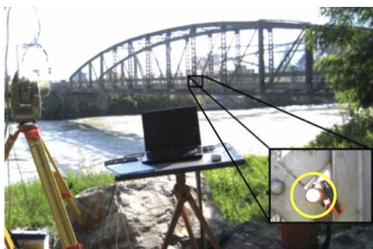
Abb. 8.113 Anwendung des Daedalus-Systems auf einer Stahlbrücke über die Rhone im Kanton Wallis (links, [236]) und an einem starren Prototyp-Träger in den ETH-Versuchsanlagen (rechts, [235]).
