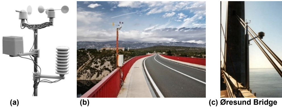
Abb. 7.41 Beispiele für Wetterstationen auf Brücken. Bild (c) wiederverwendet aus [68].
