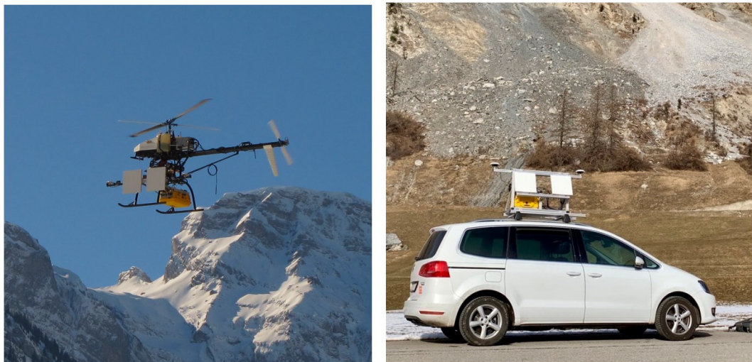
Abb. 8.122 Mobile Mapping System mit einem InSAR auf einer Drohne (links) und einem Strassenfahrzeug (rechts) [273].
