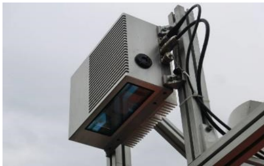
Abb. 7.102 Oberflächenscanner (links) und Prinzipskizze der Aufnahme der Strassenoberfläche (rechts) [214].
