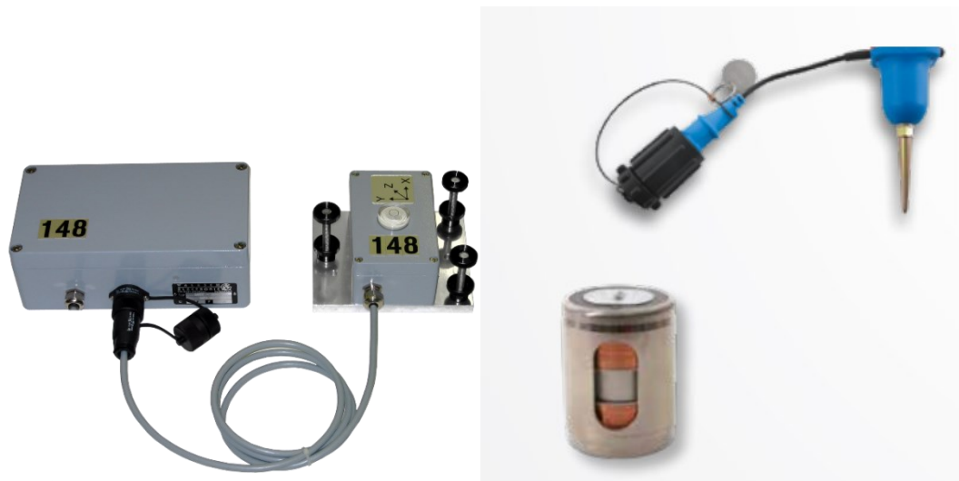
Abb. 7.38 Darstellung eines dreidimensionalen Geophons (links,[60]), Geophons für geophysische Untersuchungen (rechts oben, [61]), eindimensionale Geophons ohne Gehäuse, (rechts unten, [61]).
