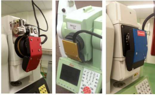
Abb. 8.110 Das Herzstück des QDaedalus-Systems besteht aus digitalen Kameras, die auf herkömmlichen Totalstationen montiert sind [234].
