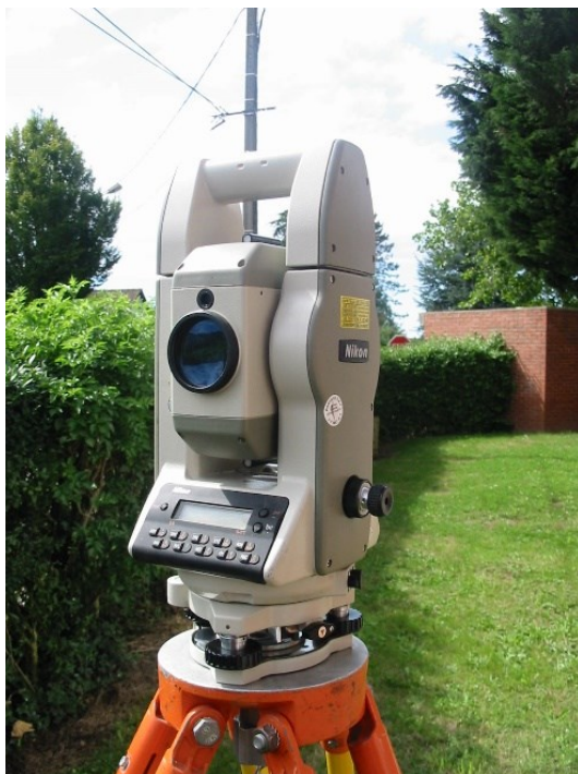
Abb. 7.107 Tachymeter als Beispiel zur indirekten Bestimmung der Neigung über grosse Messentfernungen [227].
