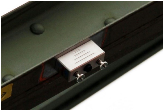
Abb. 7.80 Magnet-Dehnmessstreifen auf einem Stahlträger montiert.
