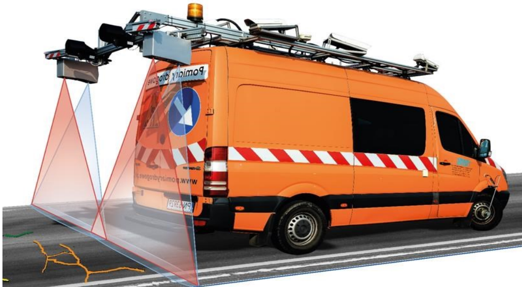
Abb. 7.104 Messfahrzeug IRIS 6 der Firma Lehmann + Partner Polska Spółka z o.o. [217].
