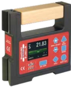
Abb. 7.106 digitaler Neigungsmesser Clinotronic Plus [226].
