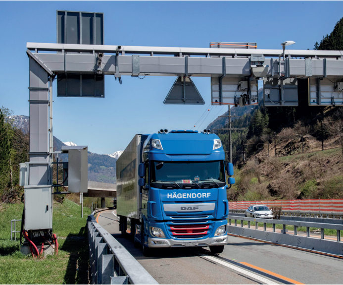
Il termoportale rileva le temperature di diverse componenti presenti sui mezzi pesanti (freni, gomme, ecc.)
