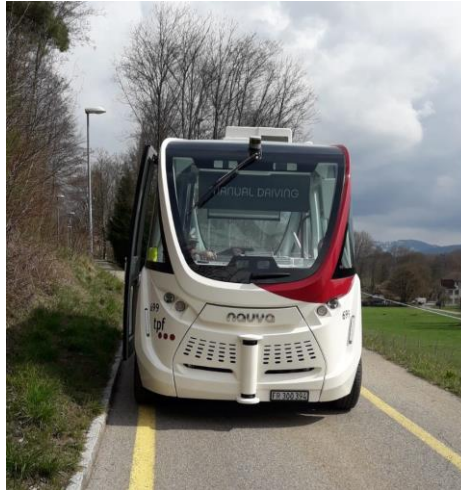
Figure 1 - Perte de localisation Route Ancienne Papeterie
