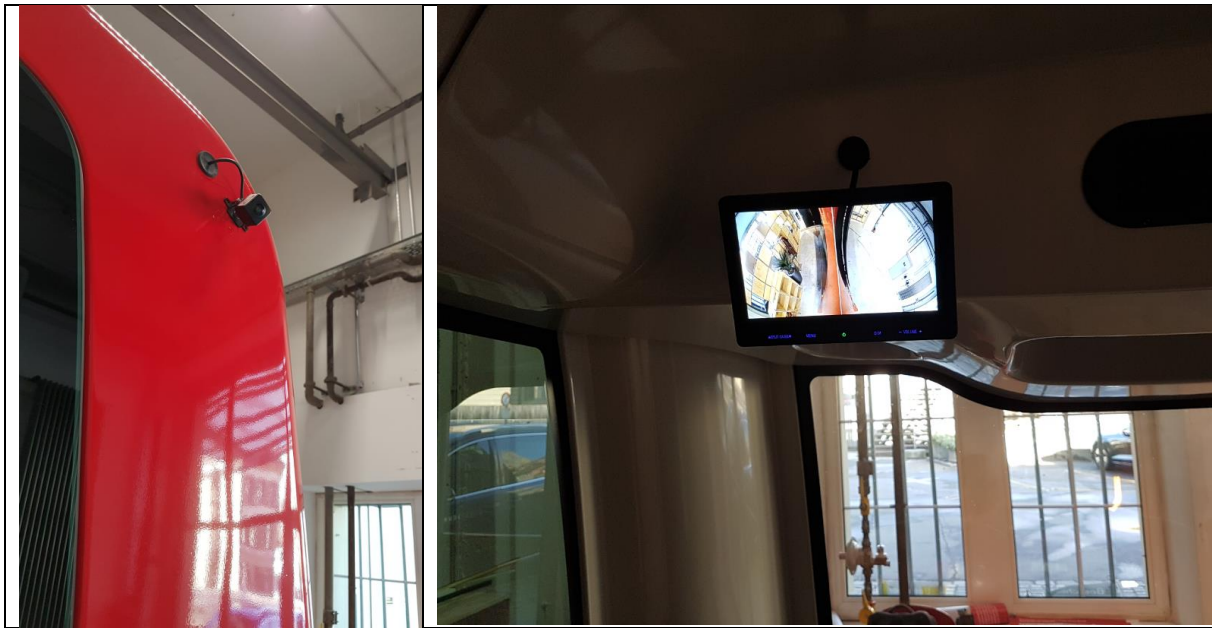
Abbildung 18: Aussenkameras zur Kompensation der Blindspots der Sensoren
