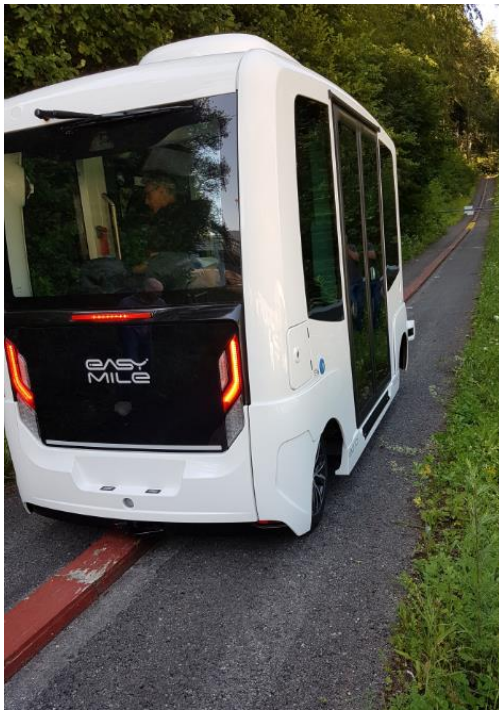
Abbildung 11: Anfahr- und Bremstest in der Steigung beim DTC in Vauffelin
