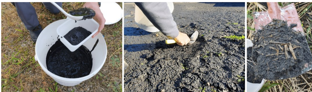
Abb. 4.1 Schlamm eines Absetzbeckens (links), Deckschicht eines Splitt-Kiesfilters (mittig) und Deckschicht eines bewachsenen Sandfilters (rechts).
