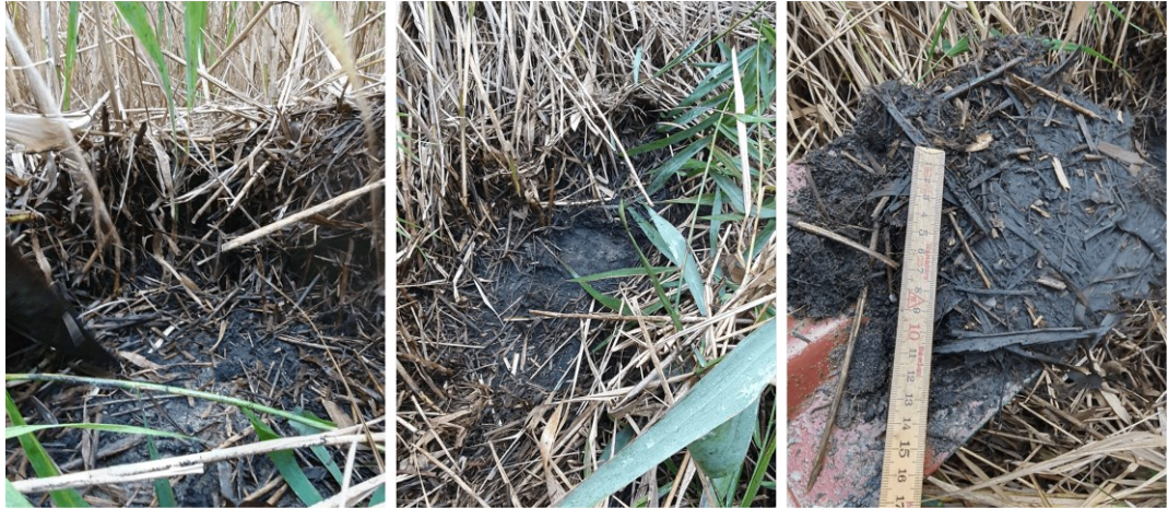
Abb. 3.3 Probenahme der Deckschicht des bewachsenen Sandfilters der SABA Rubigen.
