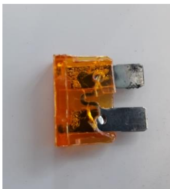
Figure 24 - Fusible pour compresseur de suspension défectueux
