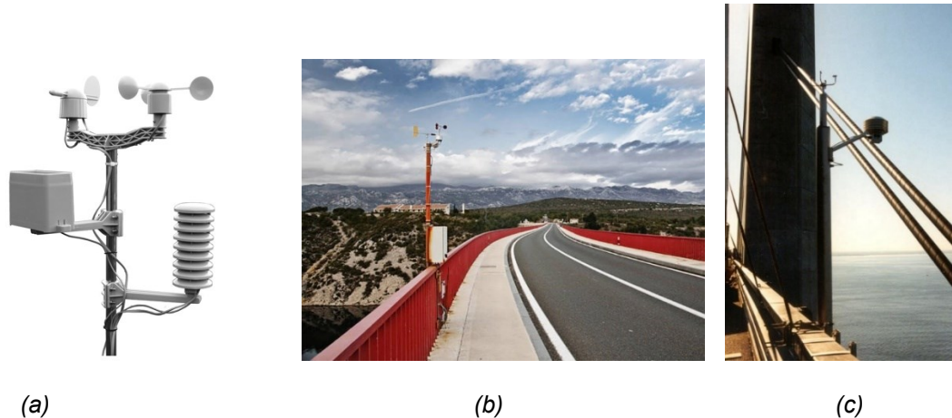
Abb. 7.26 Beispiele für Wetterstationen auf Brücken. Bild (c) für die Øresundbrücke ist wiederverwendet aus [43]
