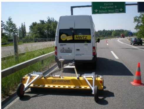
Abb. 7.113 Array System zur Untersuchung einer Brückenplatte
