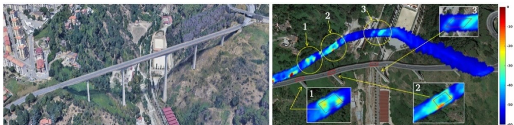
Abb. 8.133 Foto und optische Darstellung der Schwingungskarte der 'Italia'-Brücke. Quelle: [337]
