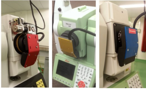
Abb. 8.143 Das Herzstück des Daedalus-Systems besteht aus digitalen Kameras, die auf herkömmlichen Totalstationen montiert sind. Abbildung entnommen aus [390]
