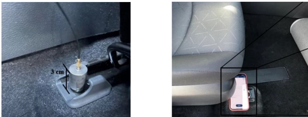
Abb. 8.135 An der Fahrzeugkarosserie montierter PCB-Beschleunigungsmesser (links), adaptiert von [348], und Smartphone (MEMS)-basierte Beschleunigungsmessung (rechts), adaptiert von [348]
