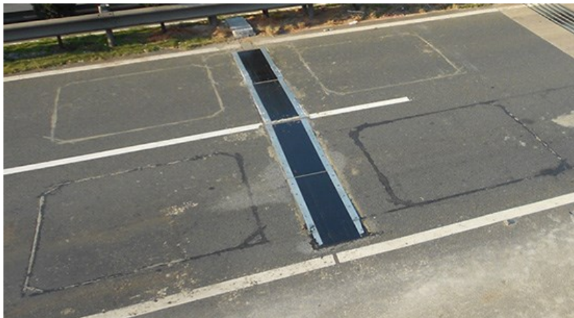
Abb. 7.30 Wiegeplatte nach dem Prinzip der Biegeplatte, bei der der das Gewicht durch die Plattenverformung erfasst wird. Quelle [48]
