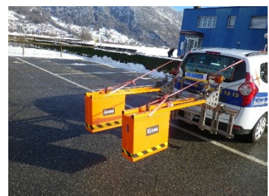
Abb. 7.112 Mobiles Georadarsystem der OST
