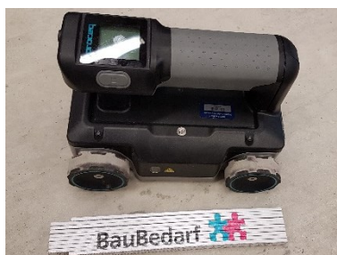
Abb. 7.110 Georadar Gerät zur Bewehrungssuche
