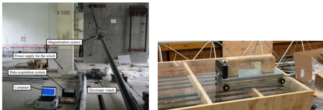
Abb. 7.118 Anwendung der magnetischen Streufeldmethode am Modell einer Schrägseilbrücken [303] (links); Laborversuch repräsentativ für Spannbeton [302] (rechts)
