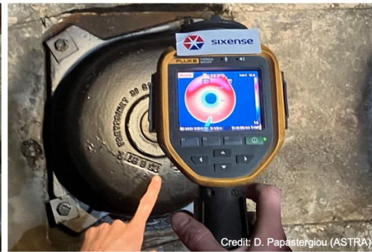
Abb. 7.129 Vorheizen der Ankerköpfe und Erkennung von Hohlräumen im Kabel mittels Infrarot-Thermografie (violette Region)
