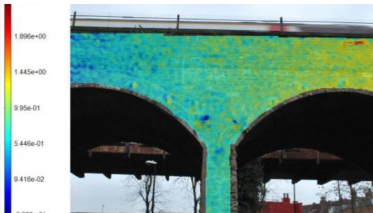
Abb. 7.84 DBK-Messung der Vertikalverschiebungen einer gemauerten Bogenbrücke aus [252]
