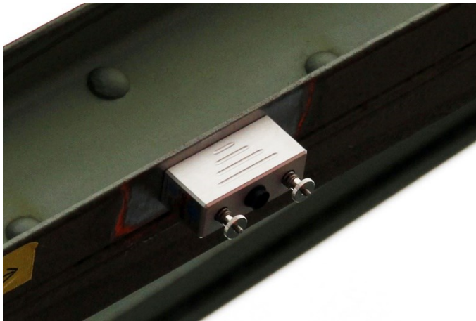
Abb. 7.64 Magnet-Dehnmessstreifen auf einem Stahlträger montiert
