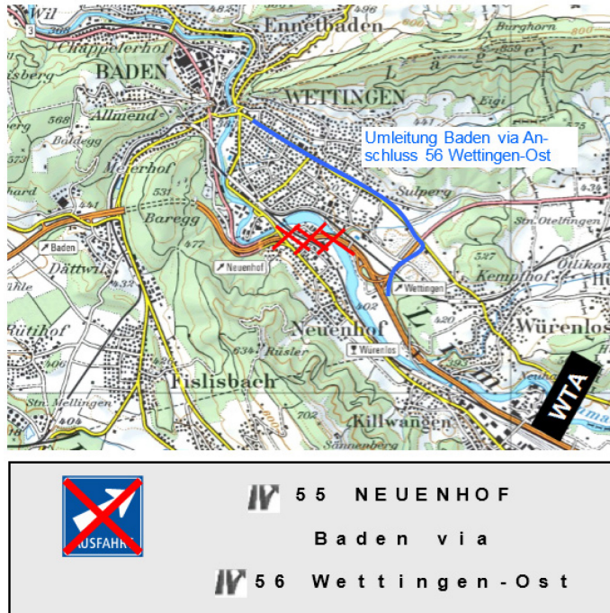
Abb. 5.25 Sperrung Ausfahrt 55 Neuenhof mit Umleitung via Anschluss 56 Wettingen-Ost.
