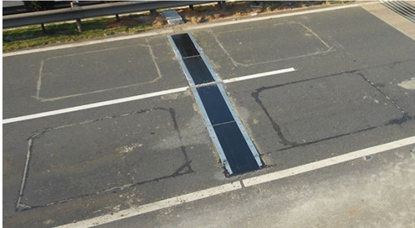
Abb. 7.90 Wiegeplatte nach dem Prinzip der Biegeplatte, bei der der das Gewicht durch die Plattenverformung erfasst wird. Quelle: [94]
