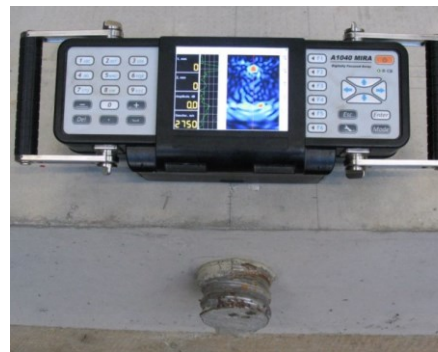
Abb. 7.63 Links: Gerät zur Ultraschall-Transmissionsmessung (proceq sa). Rechts: Gerät zur Ultraschall-Echomessung (ACS)
