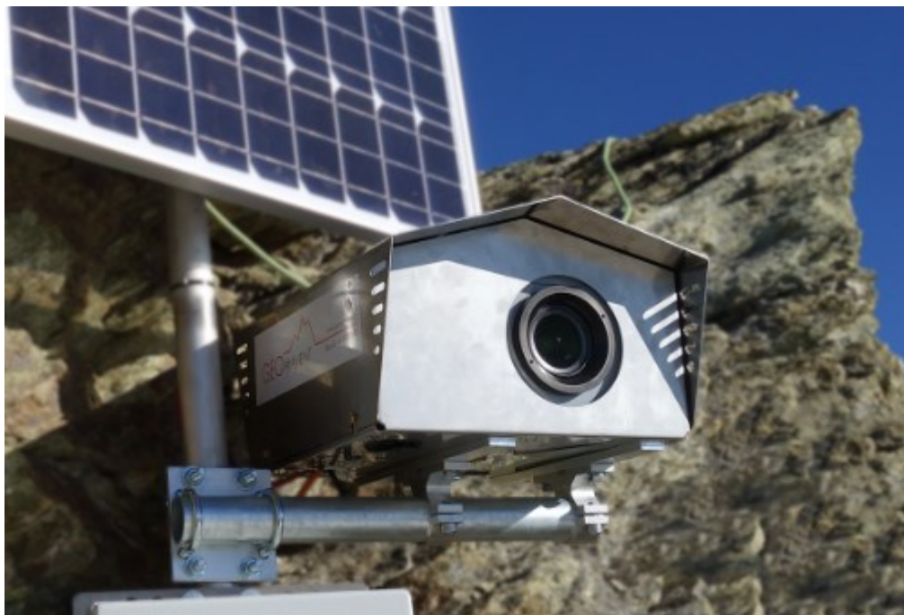
Abb. 7.114 Deformationskamera mit Solarpanel zur Stromversorgung [121]
