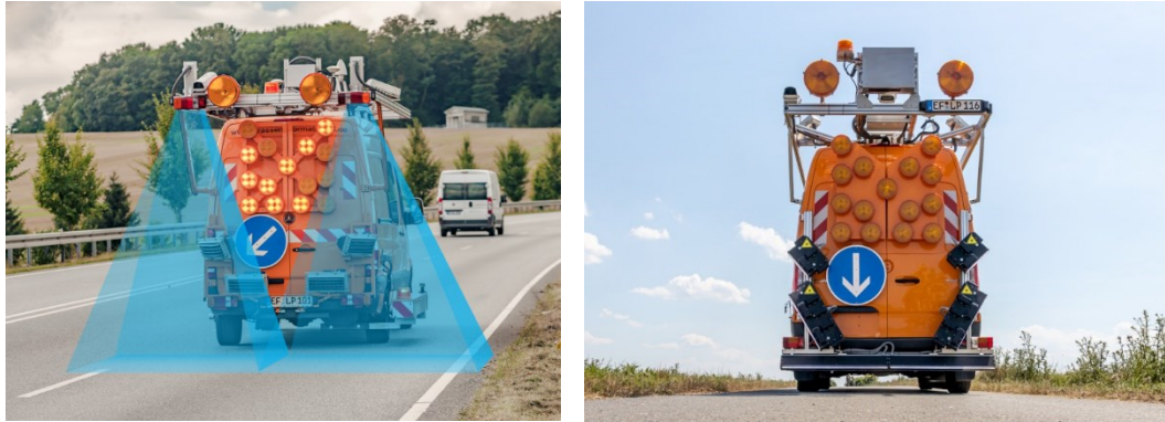
Abb. 7.52 links: Mobile Mapping System mit Flächenkameras (oben in Träger) und aktiver Blitzbeleuchtung (im unteren Bereich des Fahrzeugs) rechts: Mobile Mapping System mit Linienkamera (oben im Träger) und Konstantlichtquellen (schwarze Module im unteren Bereich des Fahrzeugs) Quelle: [LP]
