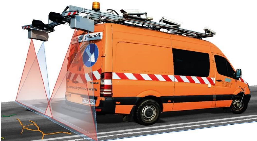
Abb. 7.46 Schema, zwei Laserlichtschnittmodule am Heck des Fahrzeuges: zwei rote Laserlinien (rot) werden auf die Straße projiziert und von zwei Kameras unter einem definierten Winkel detektiert (blau), Messfahrzeug IRIS 6 der Firma Lehmann + Partner Polska Spółka z o.o. Quelle: [LP]
