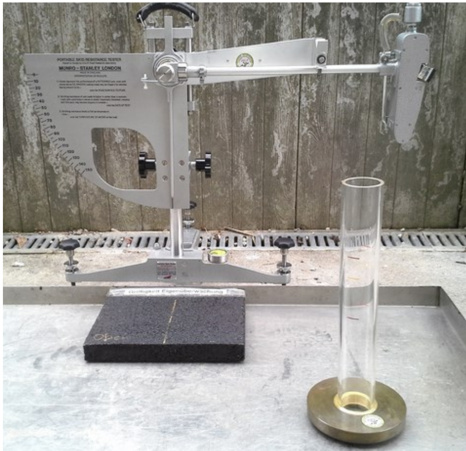
Abb. 7.15 Ausführungsbeispiel für ein SRT-Pendelgerät und Ausflussmesser, Quelle: [9]
