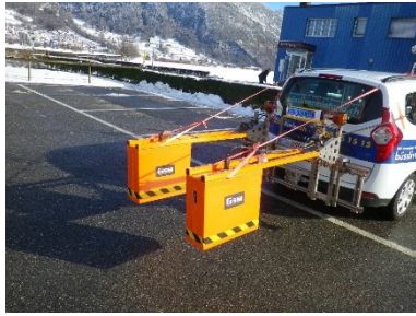
Abb. 7.62 Mobiles Georadar-System der OST, Hornantennen zur Bestimmung des Schichtaufbaus
