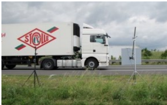
Abb. 7.92 Messtechnische Untersuchungen nach dem Verfahren der Statistischen Vorbeifahrt, Quelle: [101]
