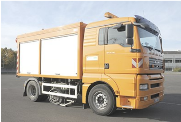
Abb. 7.17 Messfahrzeug nach der Methodes des schräglaufenden Rads, Quelle: [12]
