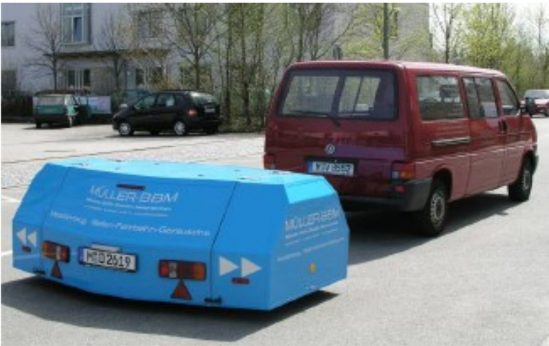
Abb. 7.91 Messtechnische Untersuchungen nach dem CPX-Verfahren, Quelle: [96]
