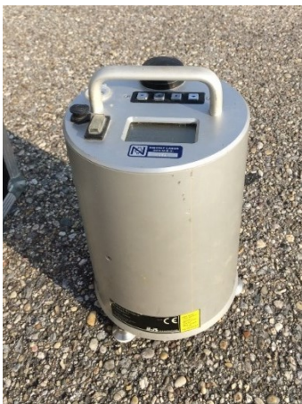
Abb. 7.22 ELAtextur® Messgerät, Quelle: [Nievelt & LP]
