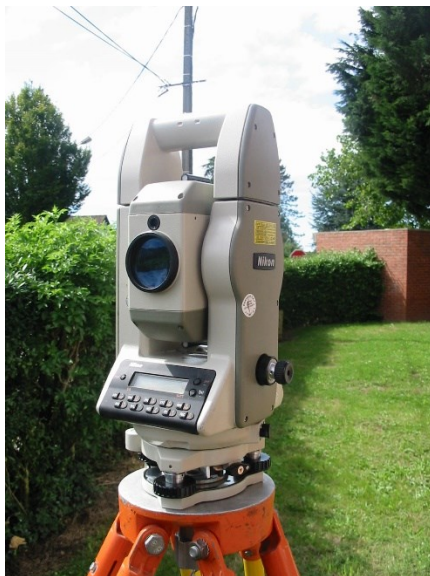
Abb. 7.49 Tachymeter als Beispiel zur indirekten Bestimmung der Neigung über grosse Messentfernungen
