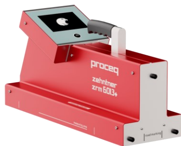
Abb. 7.26 links: mobiles Retroreflektometer für die Bestimmung von Tages- und Nachtsichtbarkeit Quelle: [4] rechts: An einem Fahrzeug montiertes, dynamisches Retroreflektometer für die Bestimmung der Nachtsichtbarkeit, Quelle: [28]
