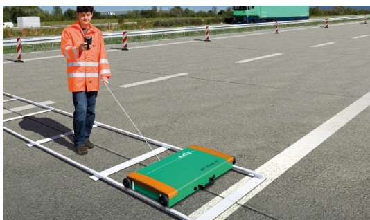
Abb. 7.75 Magnetische Dübelortung mit Schienensystem für die Sensorführung (erhöhte Ortsgenauigkeit) ( www.mit-dresden.de )
