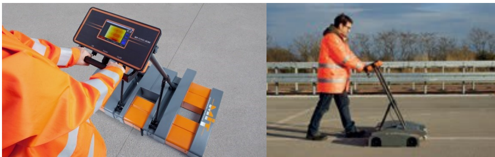
Abb. 7.74 Magnetische Dübelortung im Praxiseinsatz ( www.mit-dresden.de )
