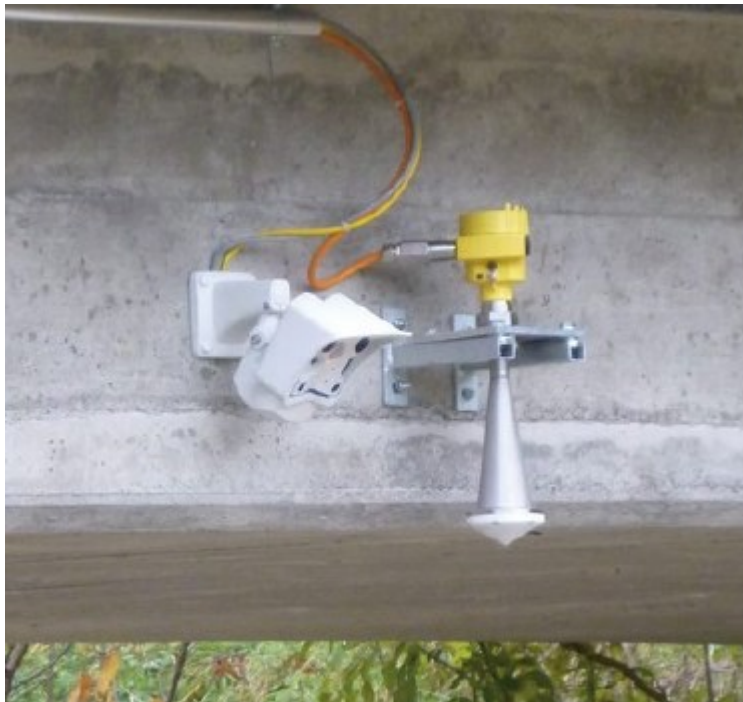
Abb. 7.111 Der Pegel-Radar (rechts) misst die Distanz zur Wasseroberfläche. Die Webcam (links) liefert zusätzlich wertvolle Bilder [108].
