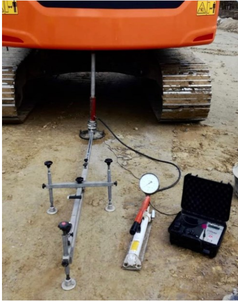
Abb. 7.80 Statischer Plattendruckversuch, Quelle: [75].
