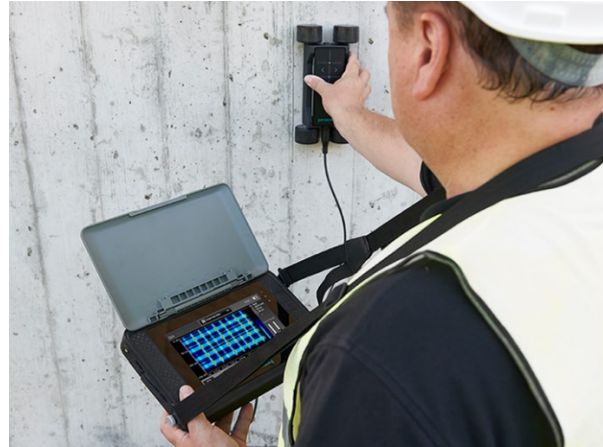
Abb. 7.73 Induktive Bewehrungsortung. Links: Einfache Handgeräte (Bosch AG, im Baumarkt erhältlich) Rechts: Professionelles bildgebendes Gerät (Proceq, screeningeagle.com )
