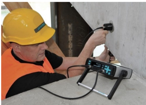
Abb. 7.63 Links: Gerät zur Ultraschall-Transmissionsmessung (proceq sa). Rechts: Gerät zur Ultraschall-Echomessung (ACS)
