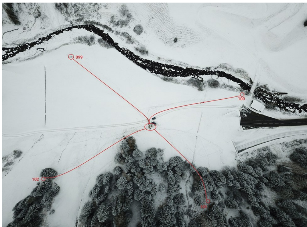
Abb. 7.112 Systemanlage Infrasound: vier Infraschall-Sensoren leiten ihre Messungen an eine zentrale Auswerteeinheit weiter [112].
