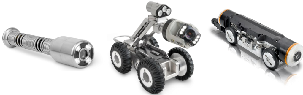
Abb. 7.99 Links: Axialkamera für den Schiebetrieb mit aktiver Beleuchtung [Fa. Ehle]. Mitte: Fahrwagen mit motorischem Heber und dreh-/schwenkbarer Kamera [Fa. Ehle]. Rechts: Fahrwagen mit hochauflösenden Fischaugenkameras und Blitzbeleuchtung [Fa. IBAK].
