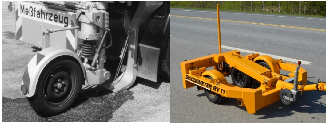
Abb. 7.19 links: Stuttgarter Reibungsmesser. Im Fahrzeug befindet sich ein Wassertank für den Auftrag eines Wasserfilms [15] rechts: Messanhänger Skiddometer, der sowohl eine Messung mit blockiertem Rad als auch mit definiert gebremsten Rad ermöglicht (vgl. 7.4)
