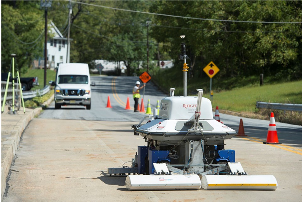
Abb. 8.129 Das System RABIT auf der Pohatcong Bridge, USA [190].
