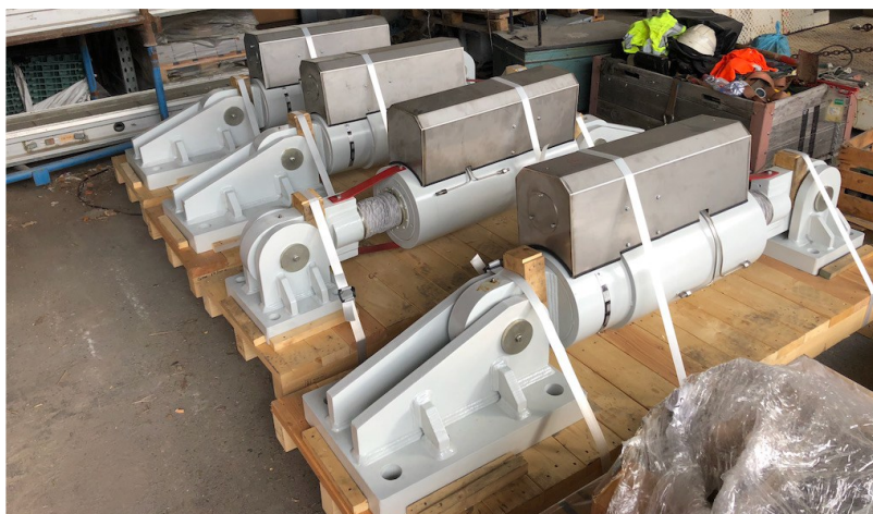
Abb. 10.16 Die vier viskosen Dämpfer (FVD), zwei pro Brücke, vor dem Einbau.
