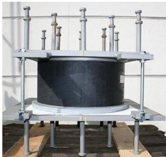
Abb. 9.5 Beispiel für ein dickes Elastomer-Lager mit einvulkanisierten Stahlplatten [108]. Rechts: Last-Verformungskurve und Hysterese.
