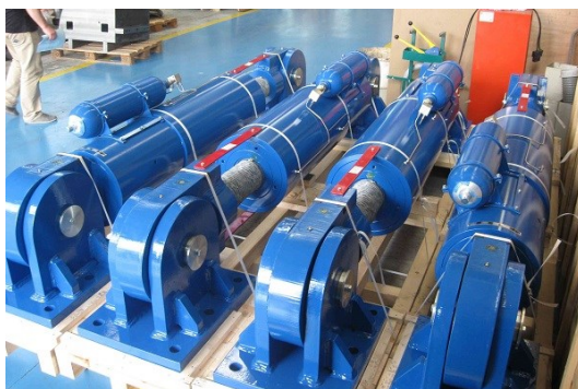
Vor dem Einbau gelagerte Dämpfer.
