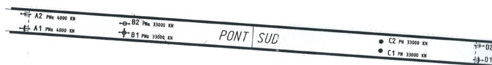
Abb. 10.14 Konzept der Auflager für die Südbrücke.
