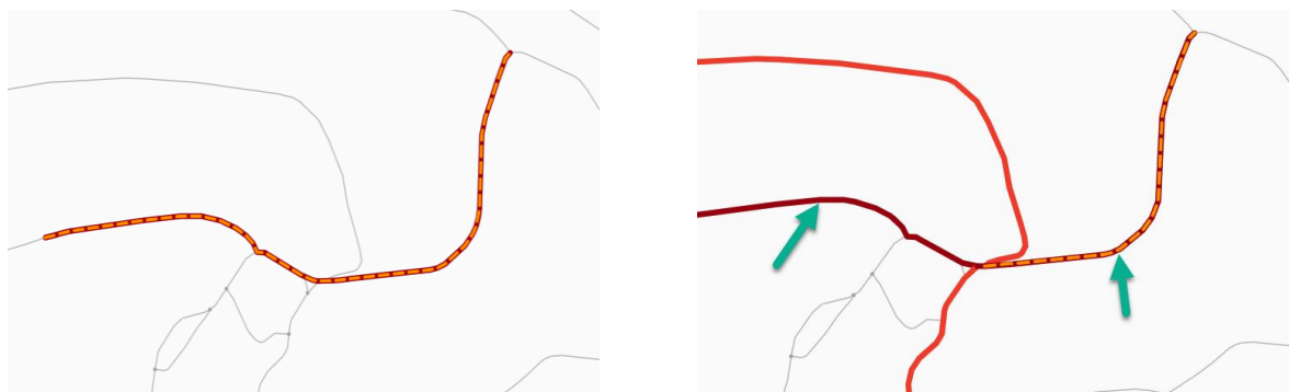
Abbildung 12 Netzabschnitt bilden: Splitten von bestehenden Abschnitten
