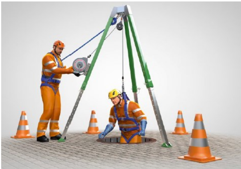
Abbildung 37: Beispiel zu einem Rettungshubsystem (Höhensicherung) 68
