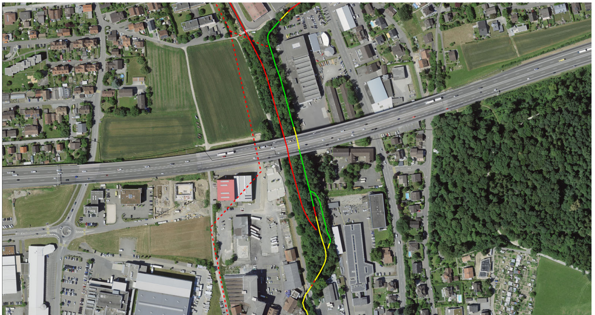
Abb. 6.23 Die Hochwasserentlastung (links, gestrichelt), der Hetex-Kanal (mittig) sowie der Aabach mit Ökomorphologie Stufe F (grün = wenig beeinträchtigt, gelb = stark beeinträchtigt, rot = naturfremd/künstlich, strichliert = eingedolt).
