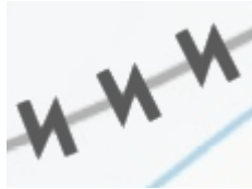
Illustration 4-146 : Tâche en attente relative à un chemin ou à un réseau sans modification de tracé
