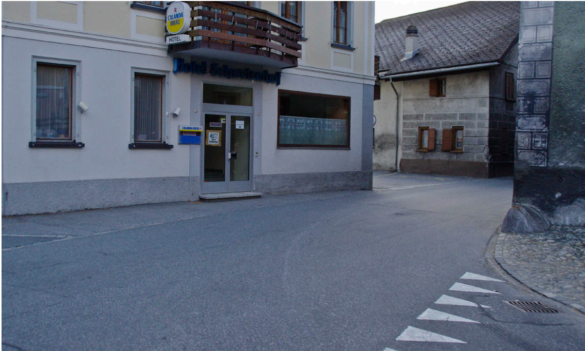
Fig. 22: Exemple de débouché avec une distance de visibilité nettement insuffisante
