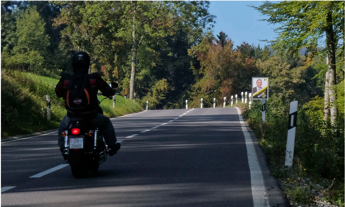
Fig. 89: Affiche électorale avec cadre massif en acier dans un endroit de chute potentiel
