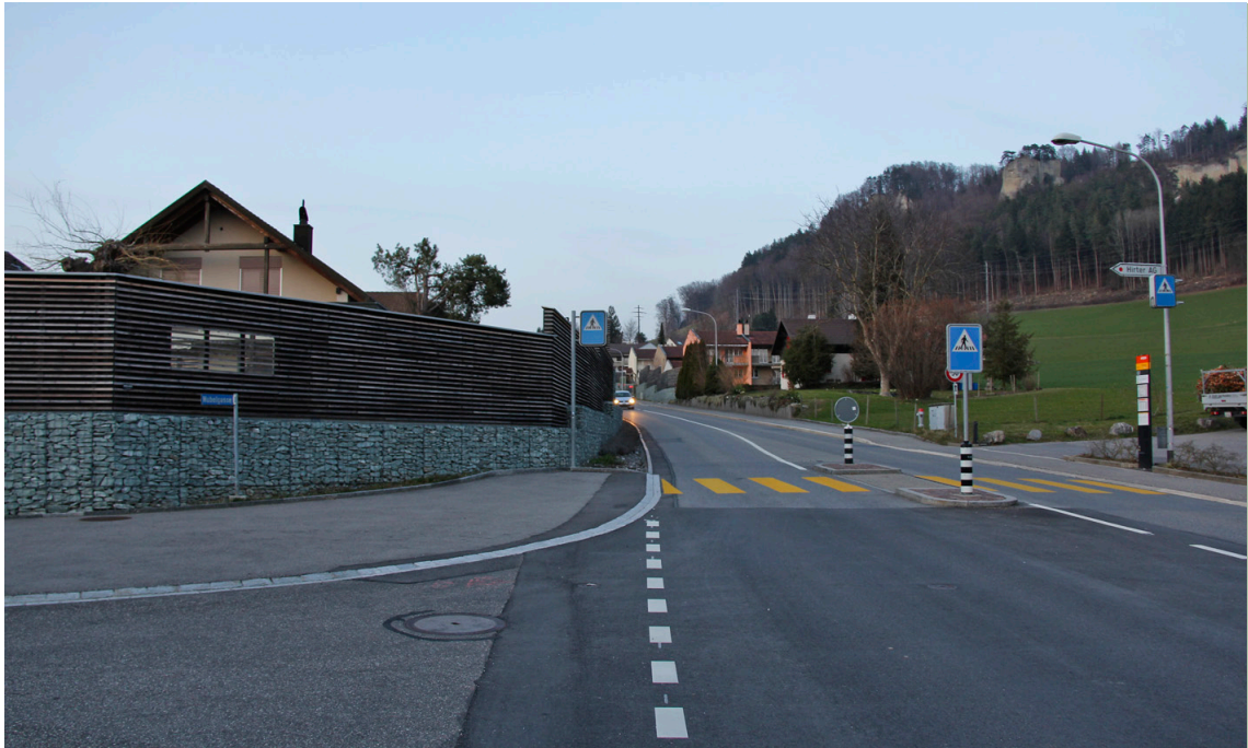
Fig. 32: Diminution de la visibilité due à des parois antibruit
