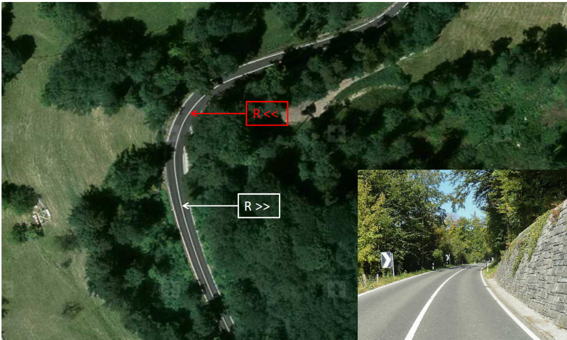
Fig. 48: Exemple de virage avec un rayon se rétrécissant
