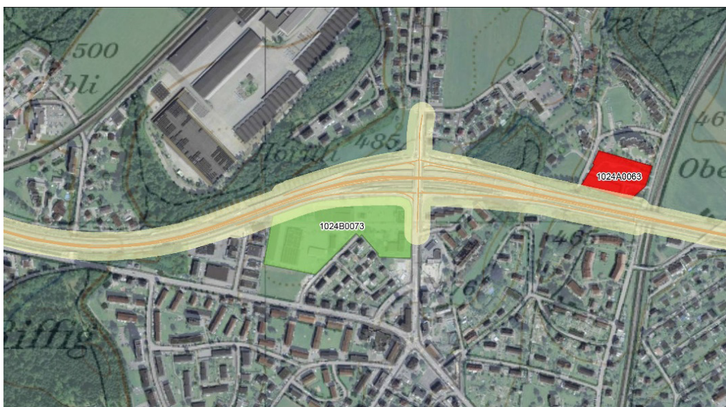
Fig. 11 : Rouge : site de stockage définitif 1024A0063 : Emmen (LU), pollué, nécessite une investigation, 5,5 % de sa surface dans le périmètre des routes nationales. Vert : aire d'exploitation 1024B0073 : Emmen (LU), pollué, nécessite une investigation, 18 % de sa surface dans le périmètre des routes nationales. 1:10 000
