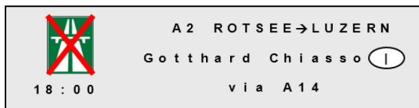
Fig. 5.18 Fermeture de l'A2 en direction de Lucerne à partir de l'échangeur de Rotsee avec 2 centres de destination importants sur des itinéraires de déviation partiellement différents.
