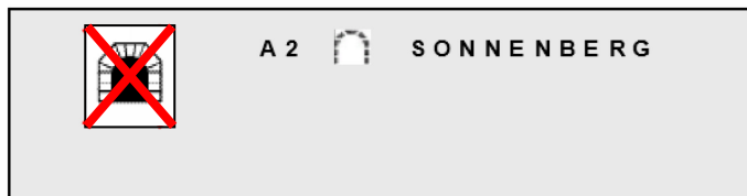
Fig. 5.15 Fermeture du tunnel du Sonnenberg en raison d'un événement, sans recommandation.
