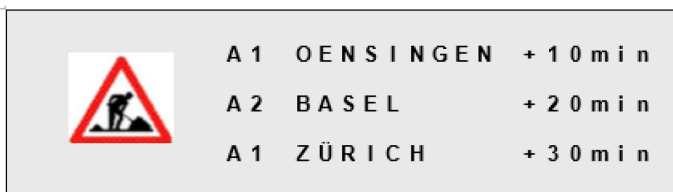
Fig. 7.12 Affichage des pertes de temps de trajet avant une zone de chantier
