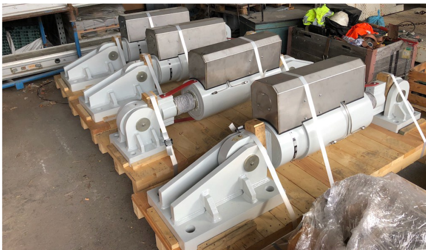
Fig. 10.16 Les quatre amortisseurs visqueux (FVD), deux par pont, stockés avant mise en place.
