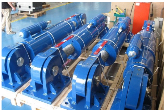
Amortisseurs stockés avant leur installation
